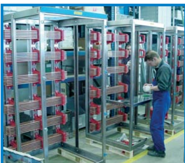
6300 A V 2 A-Felder mit Doppel-Sammelschienen für Netz und Netzersatz
