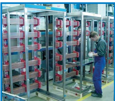
6300 A V 2 A-Felder mit Doppel-Sammelschienen für Netz und Netzersatz
