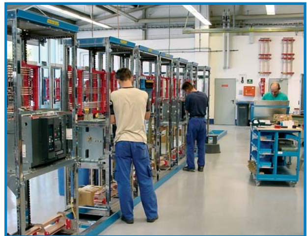
Rückwärtige Teilansicht von 4000 A Schaltfeldern
