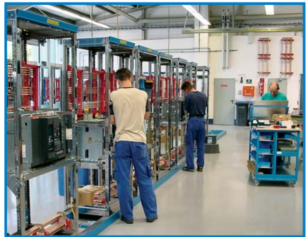
Rückwärtige Teilansicht von 4000 A Schaltfeldern
